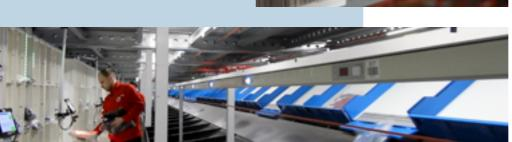
Les machines de tri sont idéales pour trier à des cadences importantes, entre 4 000 et 28 000 pièces par heure, selon leurs fonctionnalités. Elles permettent de trier un grand nombre de produits et de formats différents, allant du comprimé de quelques grammes à des cartons d'une vingtaine de kilos.
