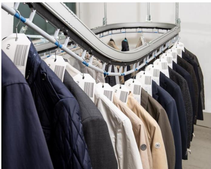
Les solutions développées par OTS se démarquent par une technologie d'entraînement par friction avec des modules fonctionnels connectables. Tel un système mécano, les modules sont interconnectés pour adosser différentes fonctionnalités et répondre aux cadences souhaitées.
